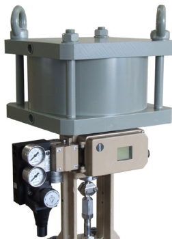
Fig. 5-3: Amplificador de inversão Tipo 3710, regulador de pressão de alimentação Tipo 4708-54 com posicionador Tipo 3730 montados num atuador de pistão Tipo 3275A
