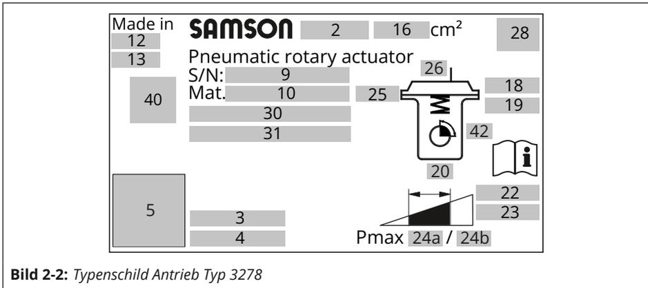
**Bild 2-2:** Typenschild Antrieb Typ 3278
