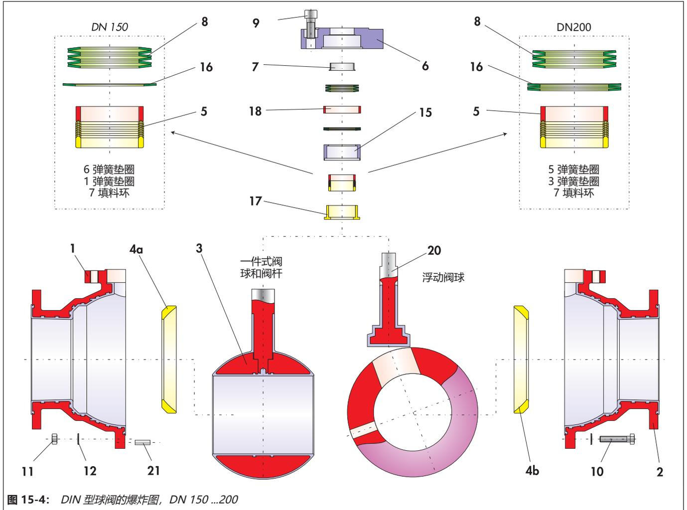
图 15-4: DIN 型球阀的爆炸图, DN 150 ...200
