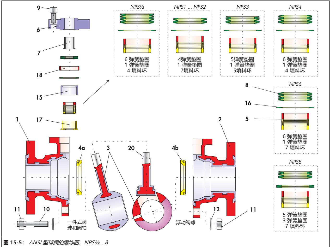
图 15-5: ANSI 型球阀的爆炸图, NPS½ ...8
