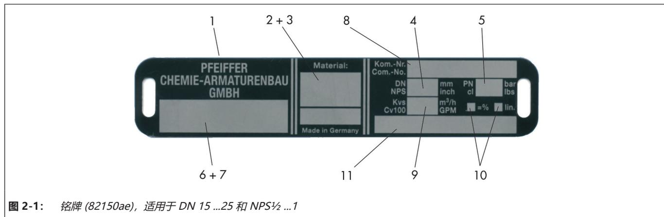
图 2-1: 铭牌 (82150ae), 适用于 DN 15 ...25 和 NPS½ ...1
