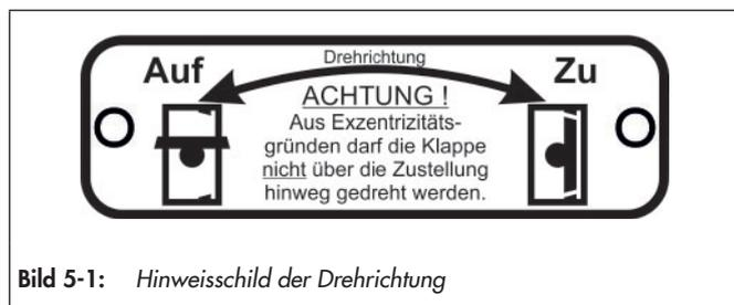
Bild 5-1: Hinweisschild der Drehrichtung
